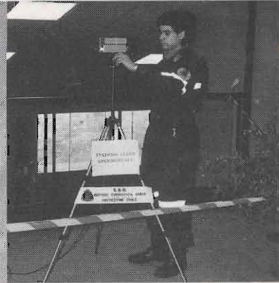
Un operatore radio collima la stazione LASER.
