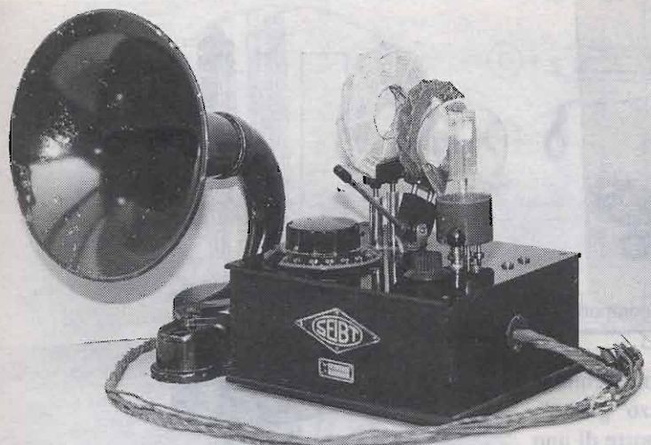
figura 5 - Ricevitore SEIBT altoparlante a tromba Brown type H4.
